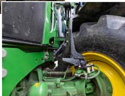
Die Kotfl gelhalter wurden nach 4500 h getauscht.
