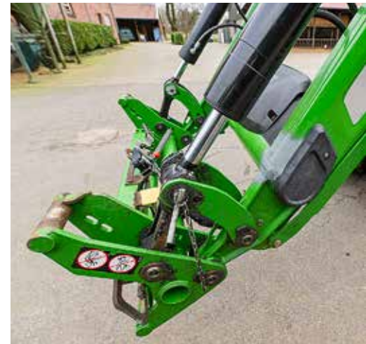
Die Schwinge ist bei 4 350 h gebrochen, Quicke zeigte sich kulant.
