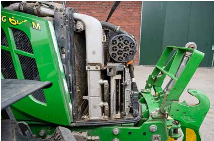
Die Kühler sind vierlagig hintereinander eingebaut. Der Zugang ist eng, ein Feingitter fehlt.
