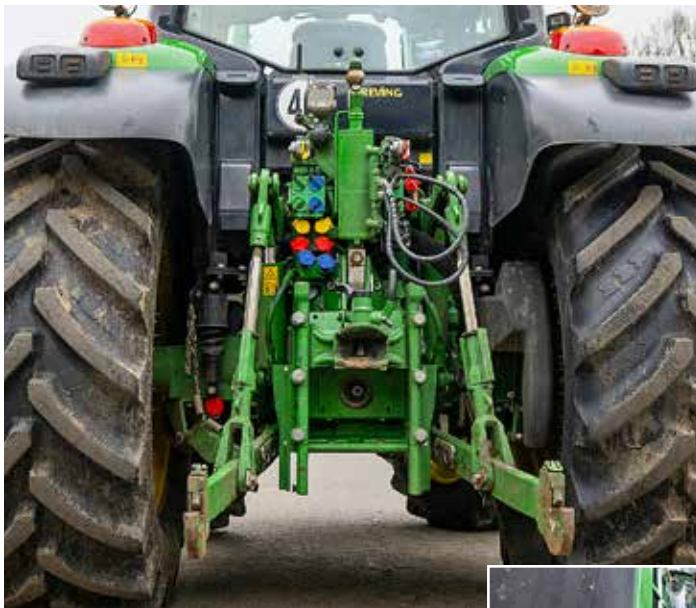
Drei Zwischenachssteuerg eräte stehen auch hinten zur Verf ugung. Bunte Kapfen gibt es f ur die  lkupplungen unterhalb der Anschl usse f ur die serienm aigen Steuerg eräte.
