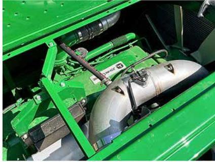
Der neue JD14X-Motor hat 13,6 l Hubraum und leistet maximal 625 PS.
