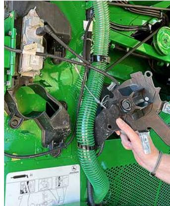
Der optionale NIR-Sensor sitzt jetzt geschützt vor dem Korn-elevator, darüber links die GrainCam und der neue Feuchtesensor.
