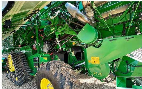
Auf der linken Maschinenseite erkennt man hinten die zusätzliche Lufthutze am Siebkasten, während der vom X9 bekannte Häckslers mit mechanischem Radialverteiler neue Paddel bekommen hat (unten).
