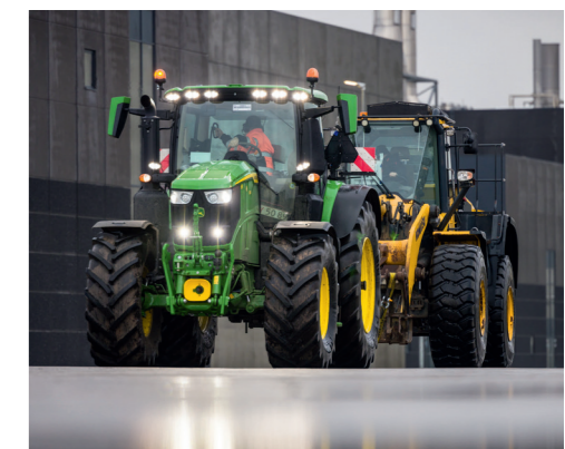
John Deere 6R 250 zieht den bremsenden Radlader. Laut Messung bringt der John Deere 80 % der angebenen Motorleistung (ohne Boost) auf die Räder. Das ist nur etwas mehr als der Durchschnitt.
