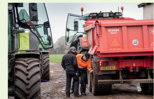
Während des Transporttests haben wir die Motor- und Getriebeeinstellungen so weit wie möglich auf Automatikbetrieb gesetzt. Der Reifendruck wurde gemäß den Reifendrucktabellen der Reifenhersteller eingestellt.
