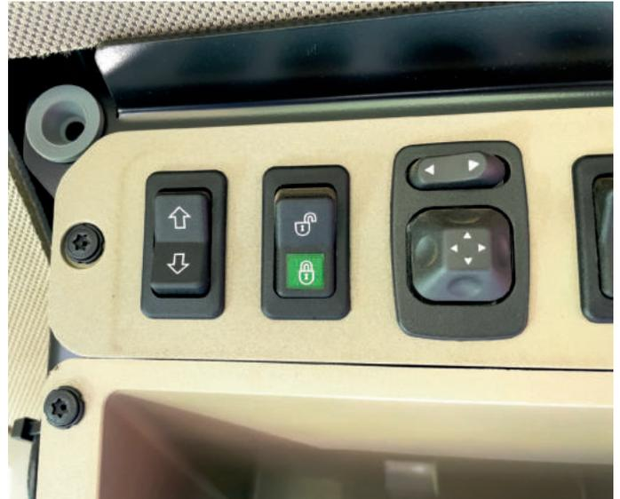
Oben findet man die beiden Bedientasten für das Unterflurgewicht. Für den An- und Abbau muss der Fahrer die Kabine nicht verlassen.
