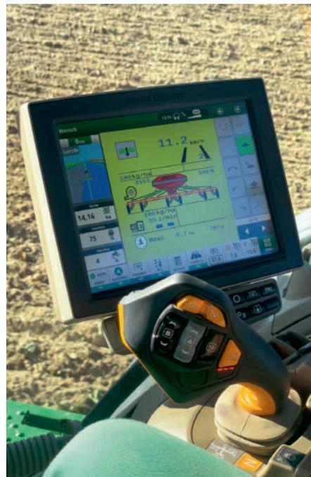
Den CommandPro-Fahrhebel gibt es nur in Kombination mit dem stufenlosen AutoPowr-Getriebe.
