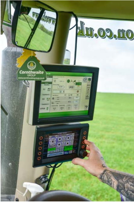
Mitarbeiter Ronnie Dots kann über die Monitore in der Kabine u. A. die Güllepumpe und die aktuellen Messwerte des NIR-Sensors überwachen.
